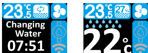
شکل ۶ - وضعیت استفاده از پمپ تخلیه در کارکرد عادی حالت اتوماتیک و هنگام تخلیه آب (در حالت سرمایشی)
