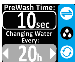
شکل ۳- تنظیم زمان های پیش شستشو و تخلیه آب (در دستگاه های سرمایشی)
