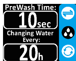
شکل ۳- تنظیم زمان های پیش شستشو و تخلیه آب (در دستگاه های سرمایشی)
