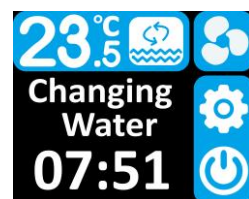
شکل ۷- وضعیت استفاده از پمپ تخلیه در کارکرد عادی حالت اتوماتیک و هنگام تخلیه آب (در حالت سرمایشی)
