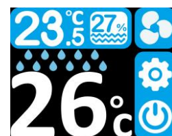
شکل ۷- وضعیت استفاده از پمپ تخلیه در کارکرد عادی حالت اتوماتیک و هنگام تخلیه آب (در حالت سرمایشی)
